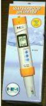
O controle da solução nutritiva envolve três parâmetros importantes: o pH, a condutividade e a temperatura. Portanto é necessário equipamentos de medição para fazer o acompanhamento destes valores. Para isto pode-se utilizar o peagâmetro e o condutivímetro portátil que fornece o pH e a condutividade elétrica, respectivamente. E em geral, também medem a temperatura.
